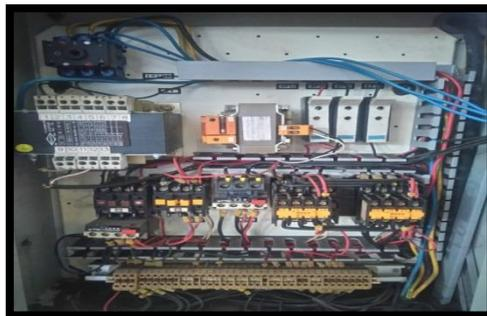
Gambar 3. Elemen kontrol pada mesin bubut Do All LT 13
